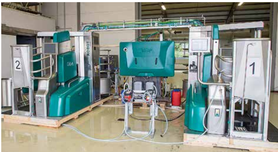
Wie viel Wasser und wie viel Strom spart eine zentrale Versorgungseinheit, wie sie hier zwischen zwei Melkboxen aufgebaut ist? – Der DLG-Test liefert hier interessante Messwerte.
