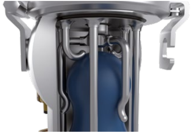
Vollständige Reinigung des Molches in der Molchreinigungsstation
